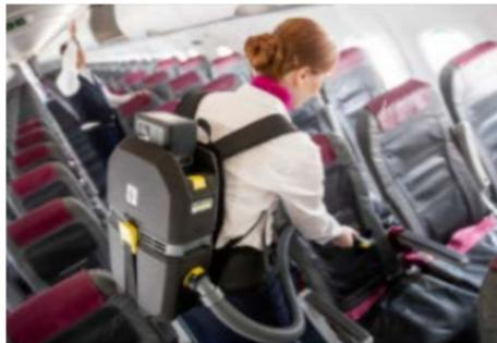
ピレン)素材を世界で初めて背負式バッテリークリーナーに採用した超軽量の背負い式掃除機で、ケルヒャーの他製品と互換性を有したリチウムイオンバッテリー「バッテリーパワープラス」仕様とすることで、業界最高水準の吸引性能を可能にした。これにより、従来のコード式キャスター型の掃除機では掃除しづらかった狭い場所や段差のある場所でも簡単に作業ができ、清掃作業員の安全性にも貢献する。
