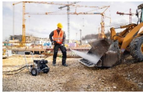
れている。本製品は使用場所を選ばないエンジン式で均一な水流を吐出できるパワーノズルを搭載する。人間工学に基づいた設計により、無理なく操作が可能で、反動を抑えたトリガーガンを採用することで、清掃作業の効率化と作業者の負担を減らすことができる。
