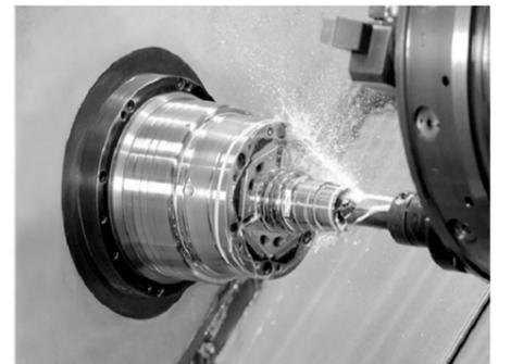
同製品は同心度5 $\mu$ m以下を実現するワンランク上の製品で、加工精度向上に貢献する。
