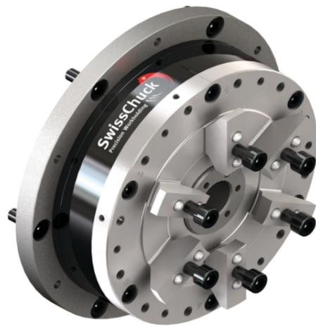
PJ」は、最高レベルの繰り返し精度2 $\mu$ m以下を保証する精密ダイアフラムチャック。クランプ時は、引き込み機能によりエンドストップにしっかり付き当たり、厳しい精度の加工にも対応する。
