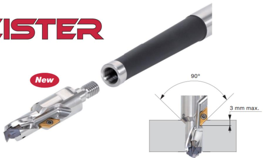
は、穴あけと面取りが1本の工具で加工可能。メトリックねじおよびユニファイねじの下穴に対応したラインナップで、専用インサートによりビビリの少ない安定した面取り加工を実現するとともに、既存のTungFlexとの組み合わせにより、工具長を簡単に延長できる。
